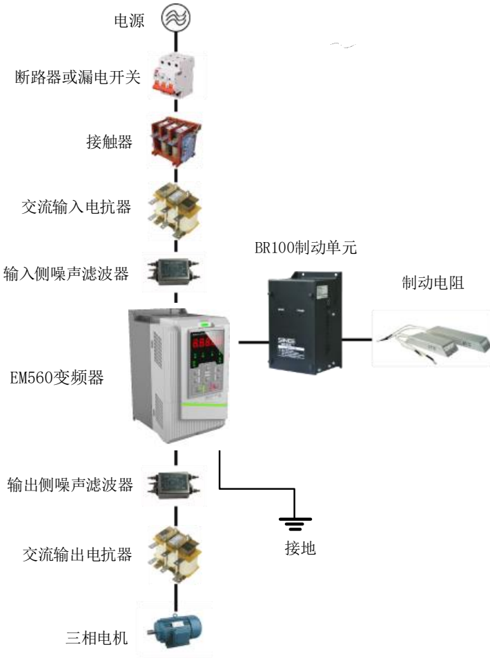
图 3-1 变频器与外围设备的连接图
